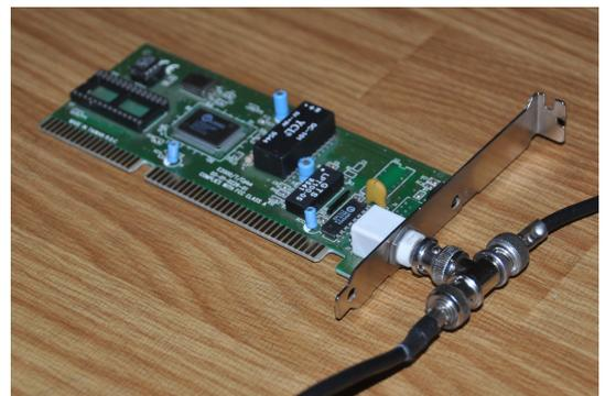
Am Ende des Kabelstrangs erfolgt eine Terminierung über einen ohmschen Widerstand (*Terminator*), der genau dem Wellenwiderstand entspricht.
